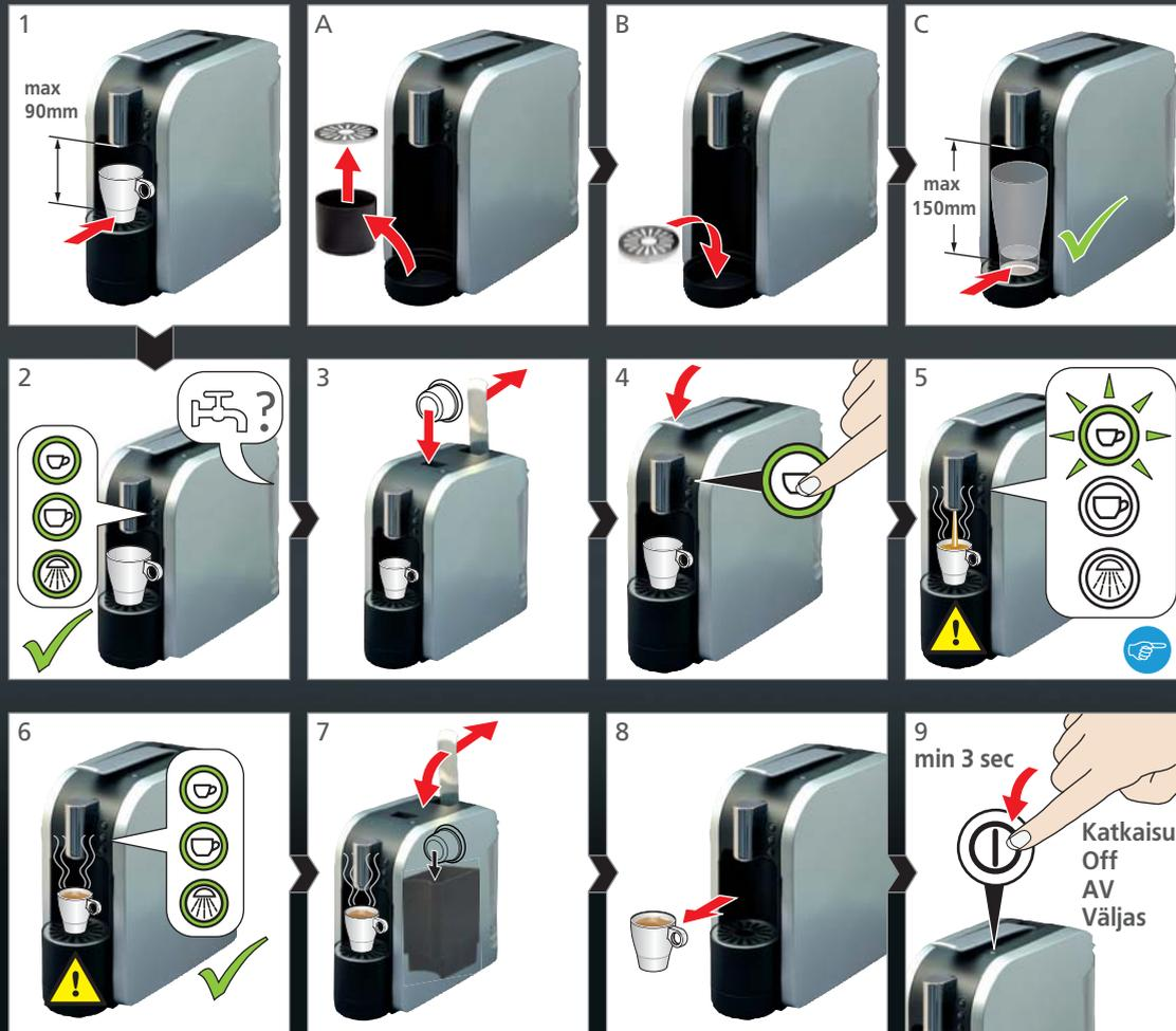
Valmistettavan nestemäärän asettaminen kuppilavuutta vastaavaksi: Pidä "pieni kuppi"- tai "iso kuppi" -painiketta painettuna, kunnes nestemäärä kupissa on sopiva. Uusi nestemäärä tallentuu ja säilyy laitteen muistissa (myös virran katketessa).
